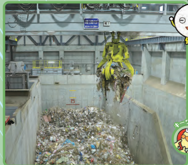
3 ごみピット・ごみクレーン ごみクレーンで焼却炉へ運びます。
